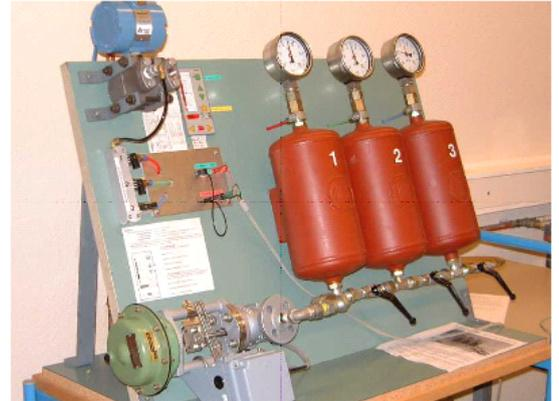
**Druckregelstrecke:** Drei Druckbehälter sind über Drosselventile miteinander verbunden. Das Regelventil ist vor dem ersten Behälter platziert.
